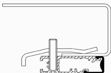
Fig. 2 Profilo da 10 mm montato utilizzando una piastra di fissaggio
