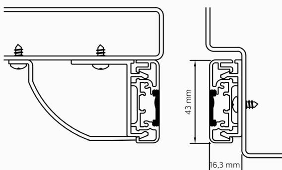
Fig. 4 Profilo da 43 mm montato per l'apertura laterale mediante una staffa a "L" con un dispositivo di protezione per le dita e una staffa sul montante di battuta
