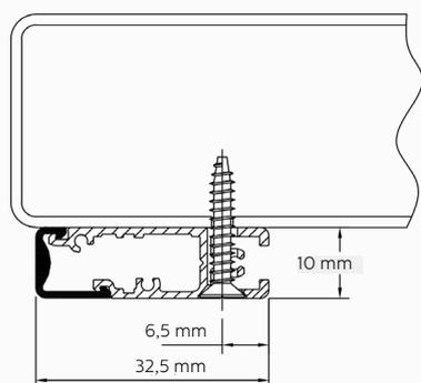
Fig. 1 Profilo da 10 mm fissato con vite autofilettante a testa svasata
